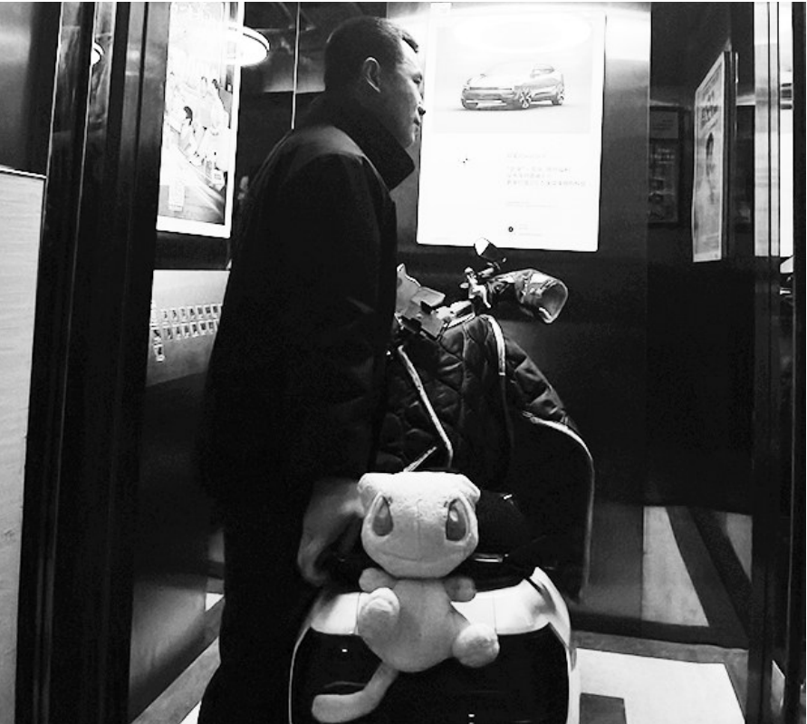
电动自行车进入电梯的瞬间立刻发出“报警提示”，电梯关门按钮同步失效。
