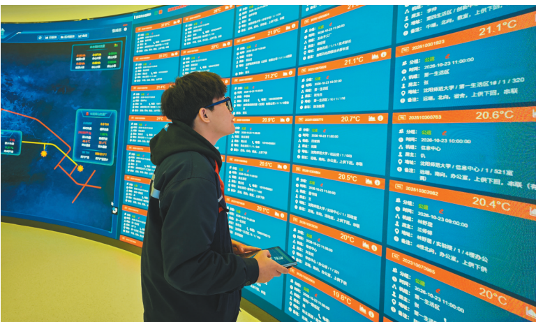
辽宁省华顺热力集团智慧供热平台前,工作人员根据实时回传的室温数据调节供热参数,提升供热温度。 本报记者 刘 桐 摄
