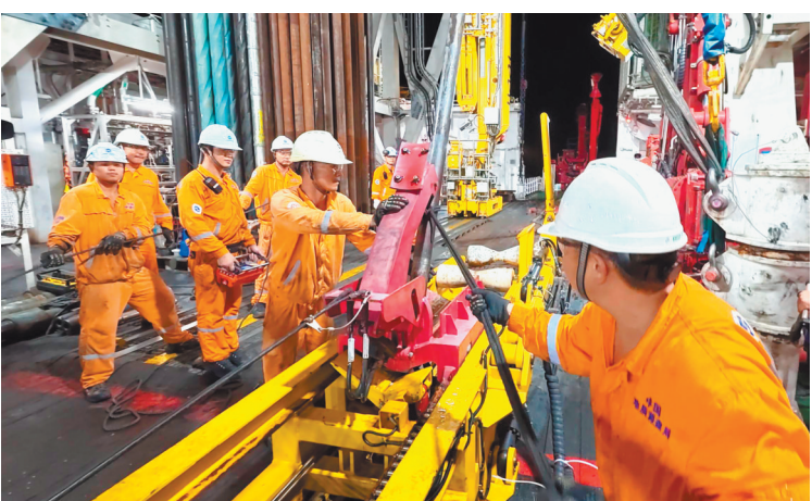
自然资源部中国地质调查局9月28日宣布，“梦想”号大洋钻探船近日在我国南海4100米水深海域完成2口井钻探取心任务，成功钻获南海洋盆玄武岩样品，我国深海钻探取心作业能力提升至5000米级。图为“梦想”号大洋钻探船开展取心作业。 本版稿件图片除转文外均由新华社发
