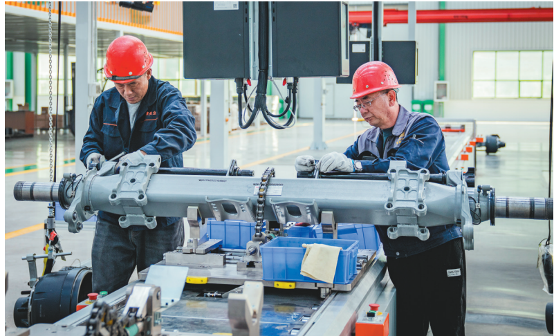
辽宁金天马专用车制造有限公司的工人在组装车桥。
