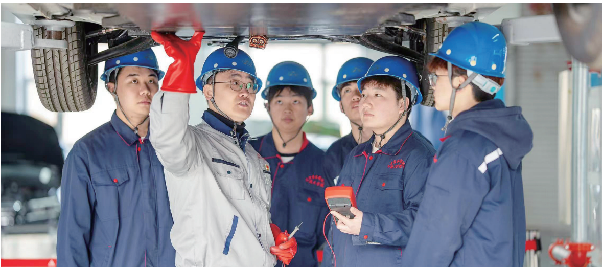
周旭带领学生检查动力电池绝缘性能。
