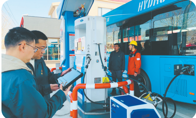
大连市计量院主导研制国产首台套直管结构70MPa压缩氢气加气机计量检定装置，为“沈大氢能高速”加氢贸易结算提供技术支持。
