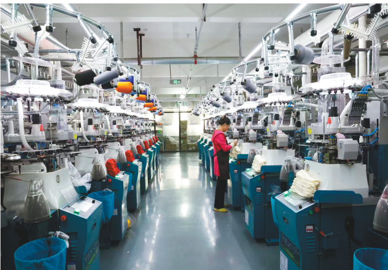
新上线的第五代袜机实现了织袜、缝头、翻袜一体化自动完成。
