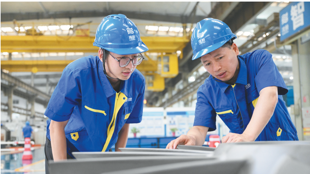
沈鼓集团转子车间数控车工、资深主任制造师马长好(右)正在加工叶轮。 本报记者 杨靖岫 摄
