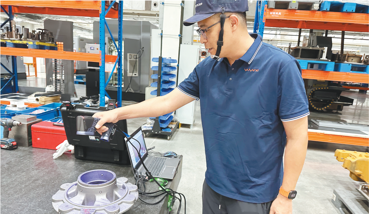
胡长江手持一台扫描枪在为刹车鼓铸件扫描建模。
