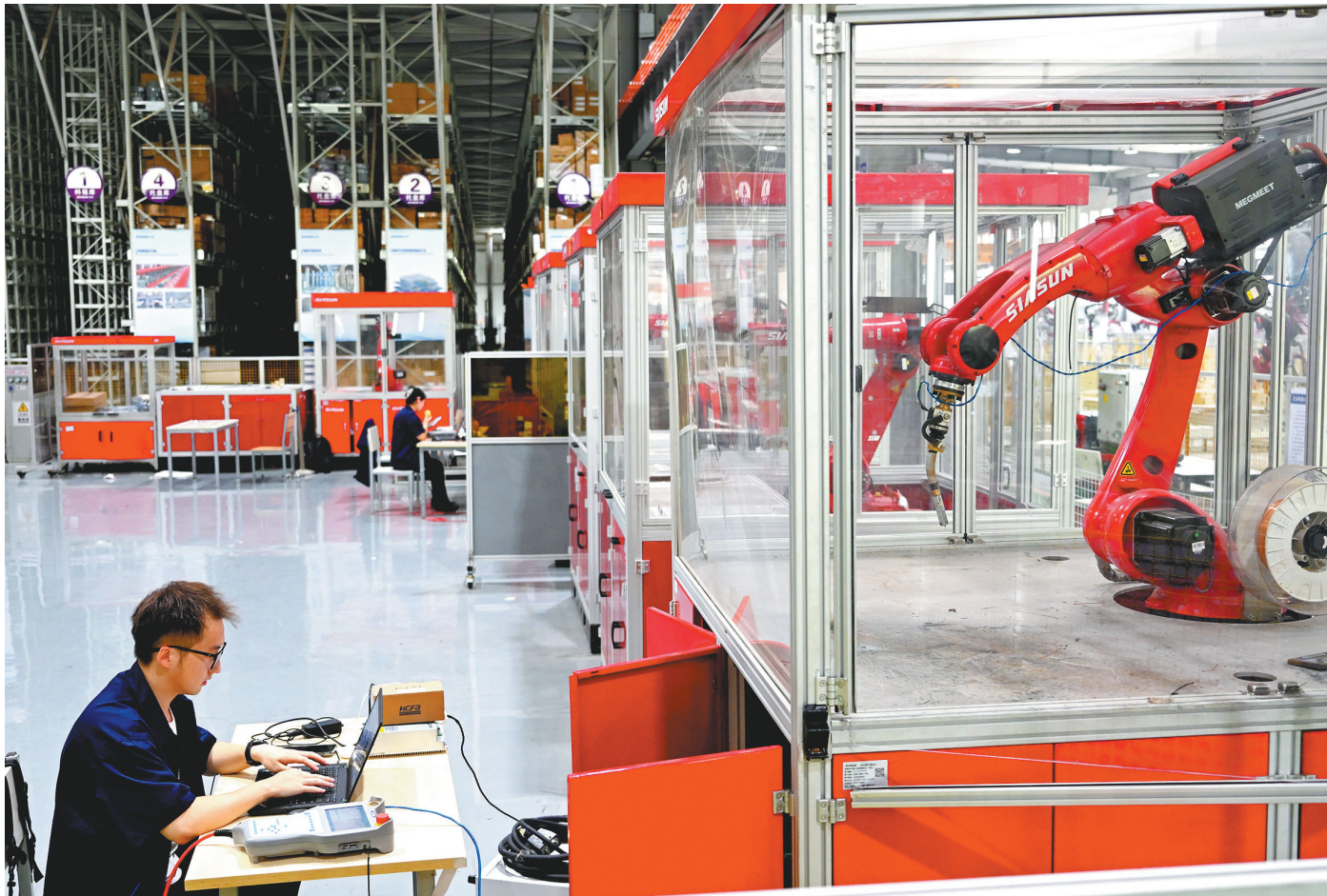
工程师正在对全新升级的新松火弧智能焊接机器人系统开展应用功能测试。
