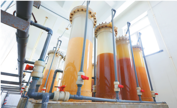
铁岭贵鑫环保科技股份有限公司利用离子交换树脂柱实现废催化剂中铂金属的高效提取。 本报特约记者 桂铁军 摄
