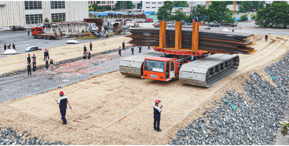
北方重工首台国内全自主研发350吨重型履带运输车圆满完成全部满载荷性能测试。 王宏涛 摄
