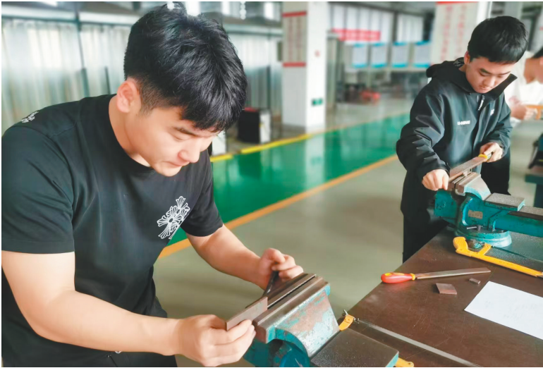
钳工课程的实训课上，抚顺职业技术学院的学生在测量工件平面。
