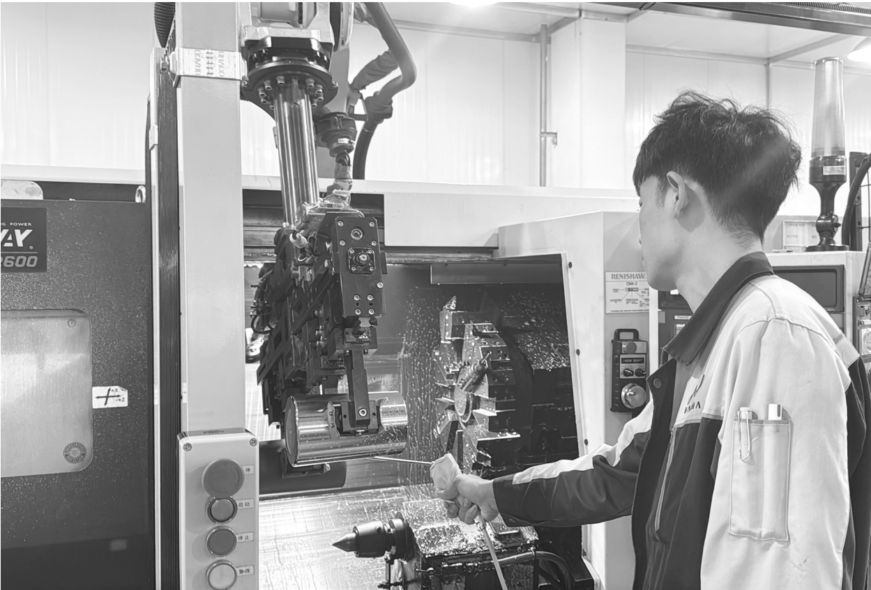
技术人员正在操作高精度机床设备进行滚动体加工。
