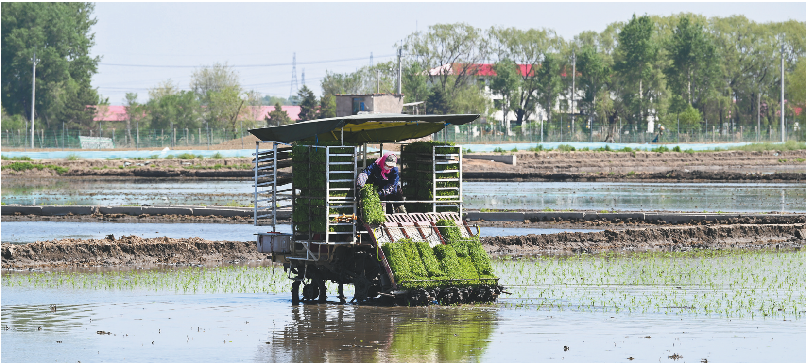
在沈阳市沈北新区，北斗导航无人驾驶插秧机在稻田里穿梭作业。
