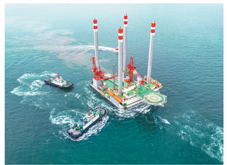
5月14日,我国首座海上移动式多功能措施平台“海洋石油283”(又称“增产一号”)从青岛西海岸新区启运,发往渤海油田。该平台采用“移动式+模块化”设计,总重7300余吨,最大作业水深40米,集酸化、压裂、调驱、调剖、稠油热采等功能于一体,并引入AI智能监测,投用后将有效支撑渤海油田增储上产。图为“海洋石油283”从青岛西海岸新区启运。
