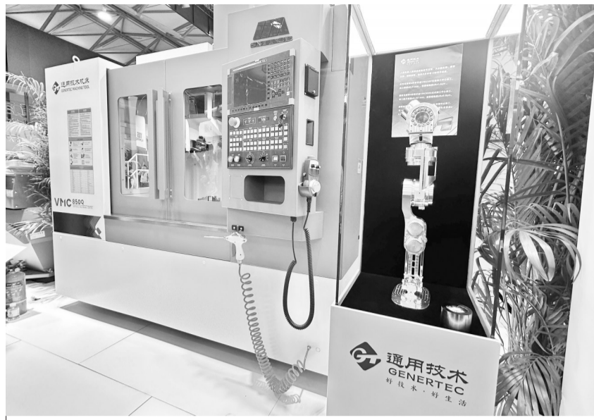
VMC850Q立式加工中心(图中左侧产品)可以保障机器人脚掌支撑、大腿支架(图中右侧产品)等结构件表面浑然一体。 图片由通用技术沈阳机床提供
