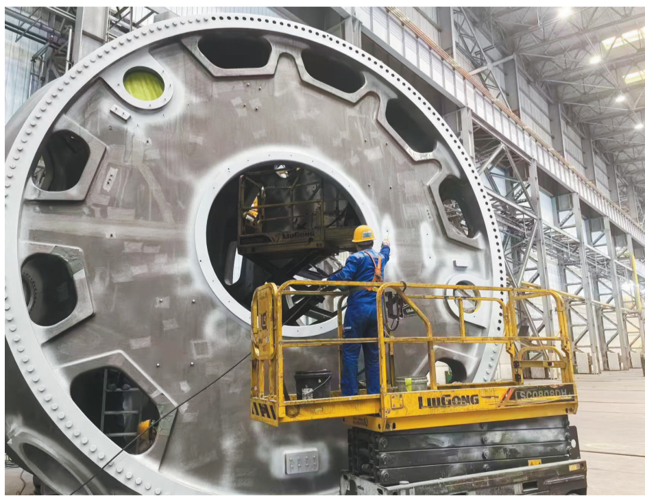
工人正在对风电轮毂产品进行喷漆防护作业。
