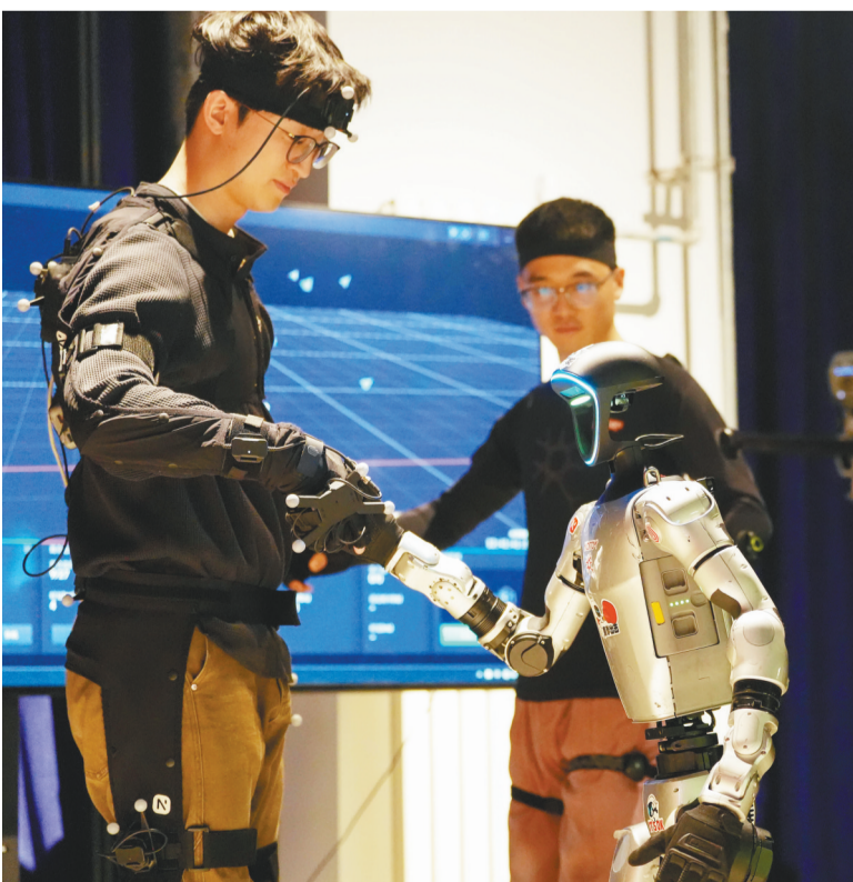
图为在北京国际科幻与未来产业博览会上，诺亦腾机器人的工作人员演示通过动作捕捉技术控制的协作机器人。
