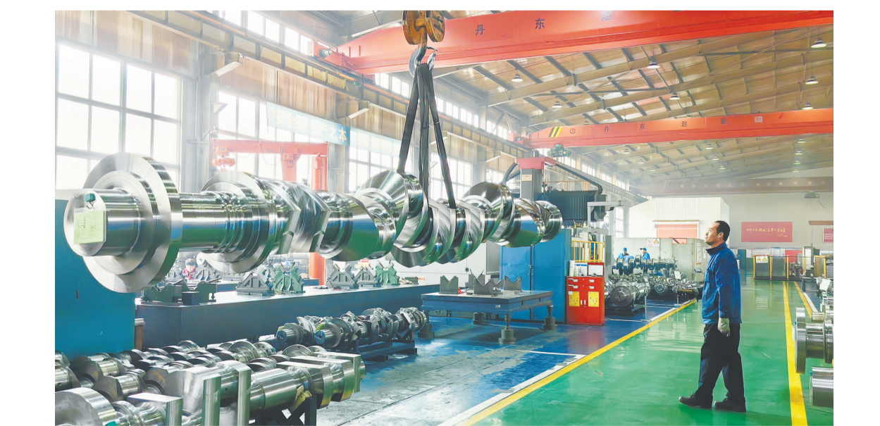
在“五一八”车间，工人在吊运整体锻轴的中速机曲轴，这一产品被誉为“技术皇冠上的明珠”。
