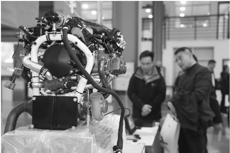
1月16日,在山河星航实业股份有限公司位于湖南省株洲市芦淞区的通航产业基地,我国第一架安装国产航电、引擎的轻型运动飞机 Aurora SA60L(“阿若拉”)在取得适航许可后正式交付客户,这一关键核心技术突破,填补了国产航电、动力轻型运动飞机的空白,提高了我国在这一领域供应链自主可控的能力。图为轻型运动飞机“阿若拉”安装的国产引擎宗申CA500发动机。
