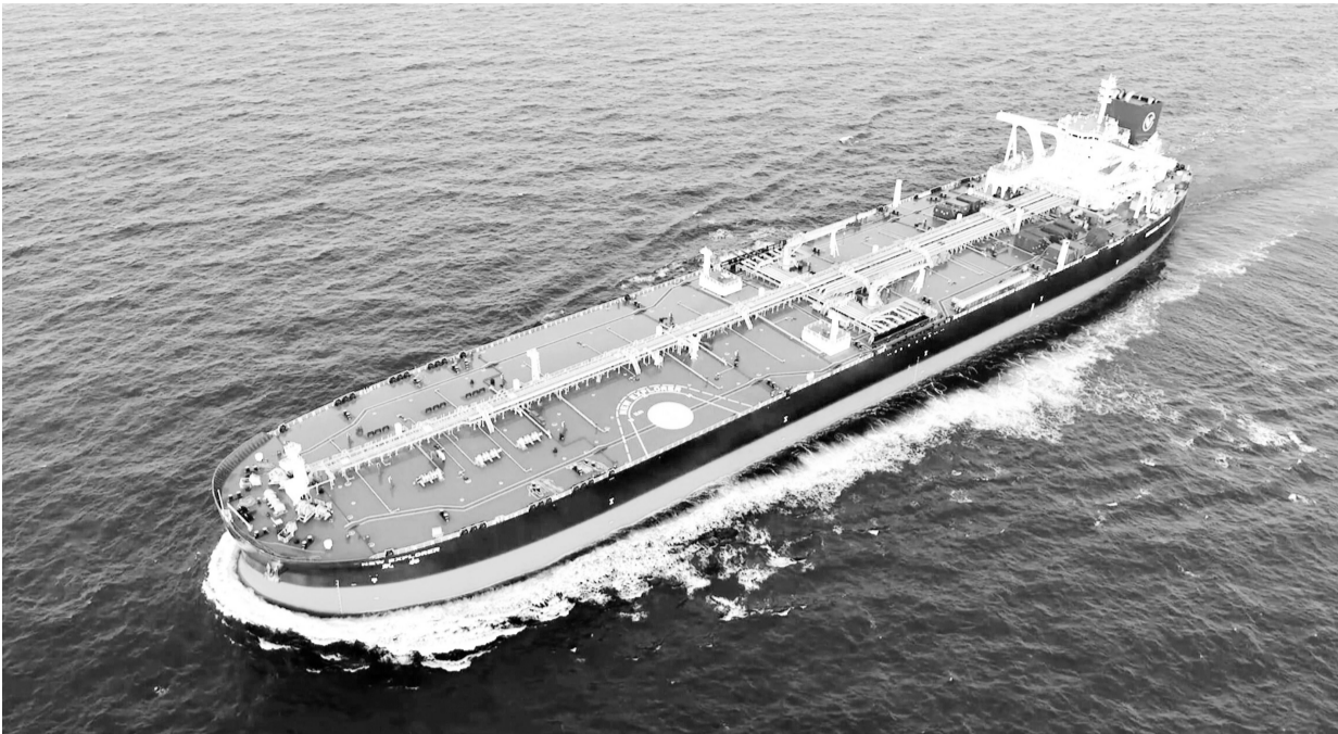
图为全球首制甲醇双燃料动力智能超大型油轮。
