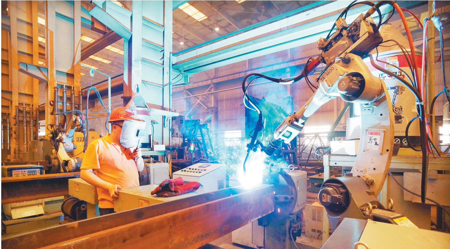
抚顺永茂建筑机械有限公司车间内,机器人正在焊接作业。
