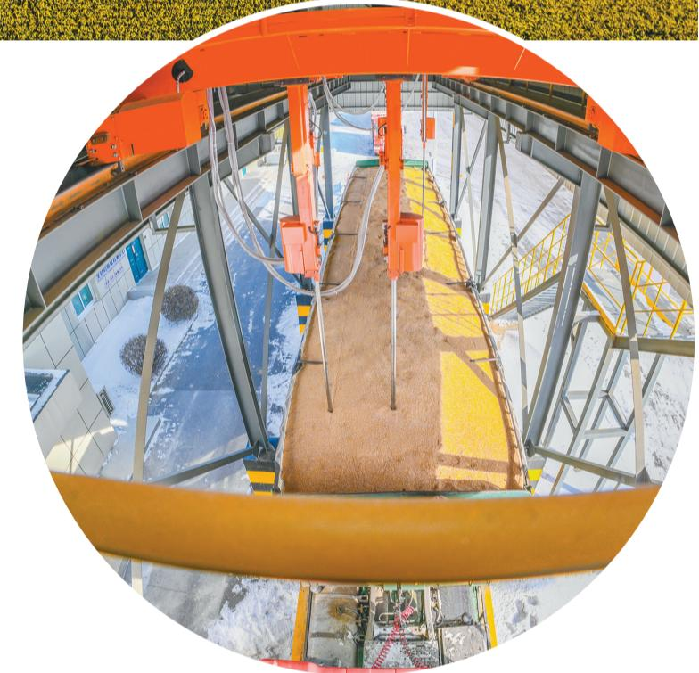
中粮米业(沈阳)有限公司通过智能扦样机器人，实现了扦样的自动化操作。
