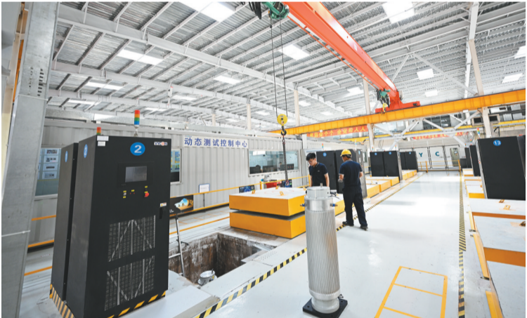
沈阳微控飞轮技术股份有限公司建立了国内唯一量产的磁悬浮储能飞轮产线。
