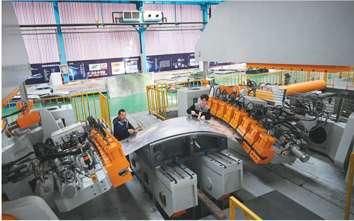
沈阳航空智造有限公司国产大飞机蒙皮生产线上工人正在生产。
