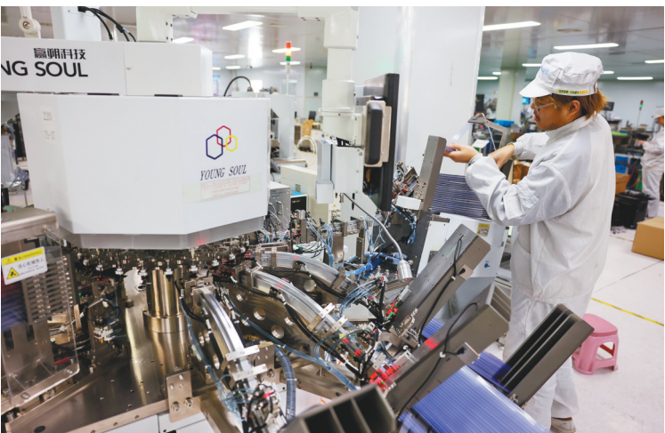
泽华电子员工使用转塔测试设备对芯片进行封装测试。
