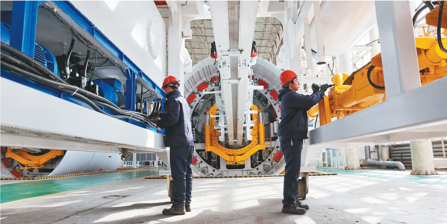
在三三工业公司装配车间，工作人员正在为即将交付使用的两台复合式土压平衡盾构机做最后的组装调试。
