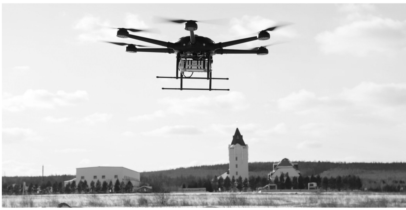
六旋翼无人机在漠河-36℃酷寒环境中试飞成功。
