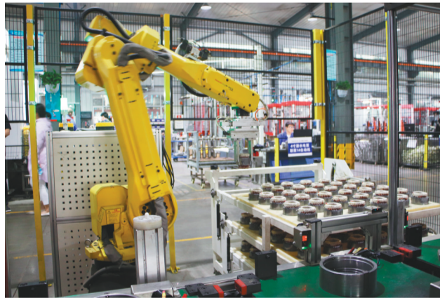
海城三鱼泵业有限公司车间里,机器手臂正在组装水泵。
