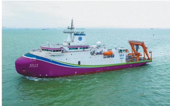
“探索三号”在试航(10月26日摄，无人照照片)。深远海多功能科学考察及文物考古船“探索三号”12月6日在广州南沙交付。此船具备完全自主知识产权，是我国首艘具备全球(含极区)深远海探测和冰区载人深潜支持能力的综合科考船。“探索三号”船长约104米、排水量约1万吨，具备船、艇双向破冰能力，续航力为15000海里，载员80人。既可以进行深海科学考察及文物考古，还可在夏季进行极区海域科学考察，将使我国载人深潜能力从全海深拓展到全海域，有效提升我国深海考古作业能力。
