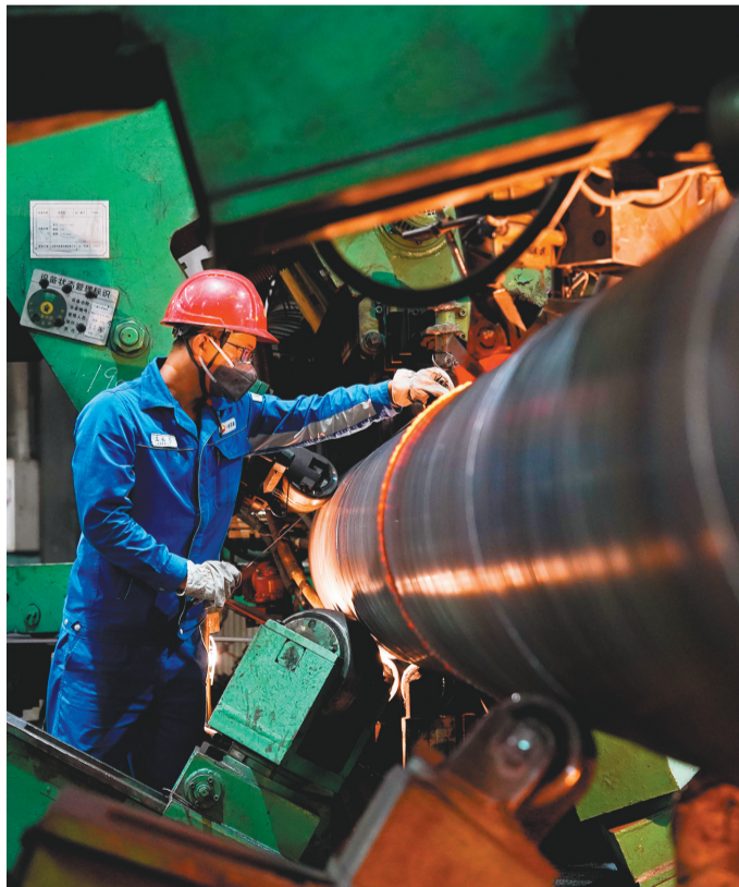
成型工正在监测钢管成型后的管径大小。
