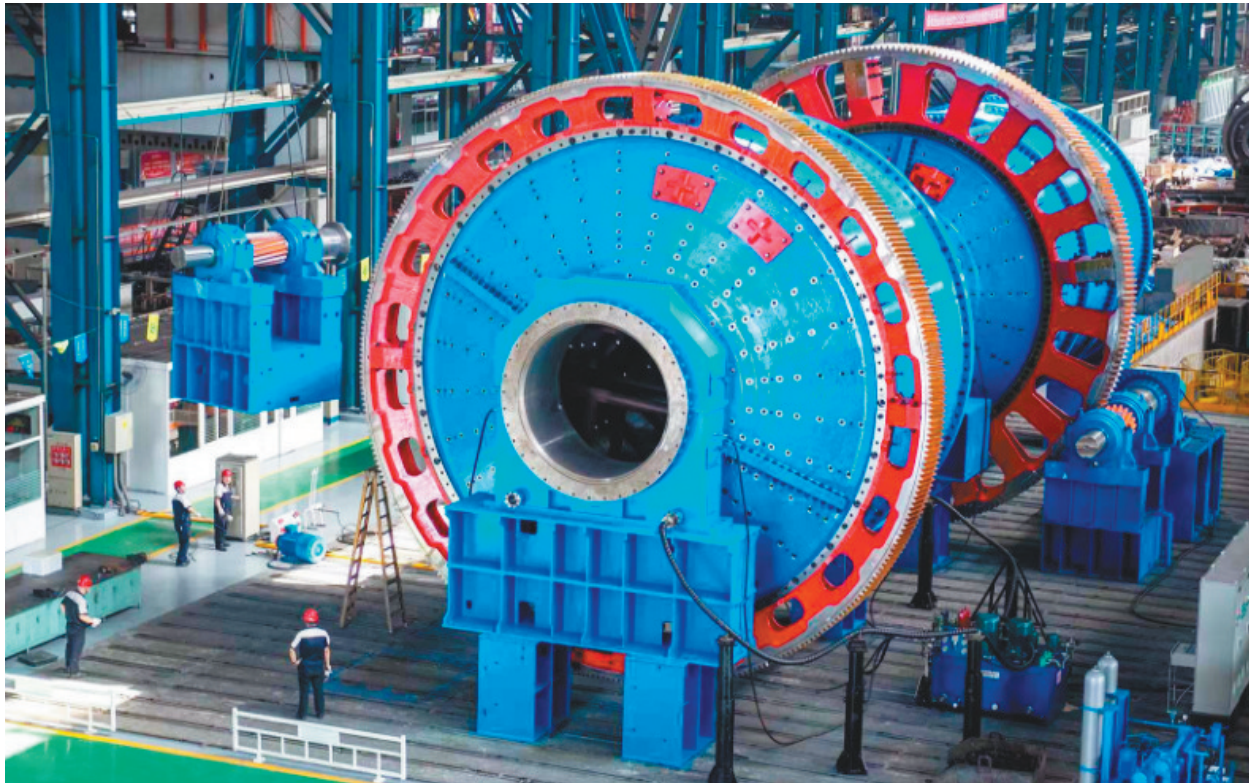
北方重工出口厄立特里亚阿斯拉多金属矿项目的φ7.9×4.8m湿式半自磨机和φ6.4×9.7m溢流型球磨机。王宏涛 摄
