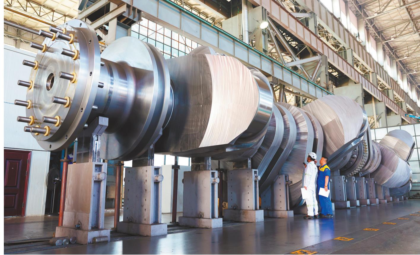
本报讯 记者王榮琦报道 9月29日,大连重工装备集团下属大连华锐船用曲轴有限公司研制的世界首支、全球最大24000TEU甲醇双燃料动力集装箱船用曲轴12G95ME-C10.5成功下线,完成了“全球首制”。12G95ME-C10.5船用曲轴采用对接式结构,总长度23.67米,重量达到539吨。该型号曲轴从曲轴毛坯、加工制造工艺到整体热装及加工全部实现国产化。
