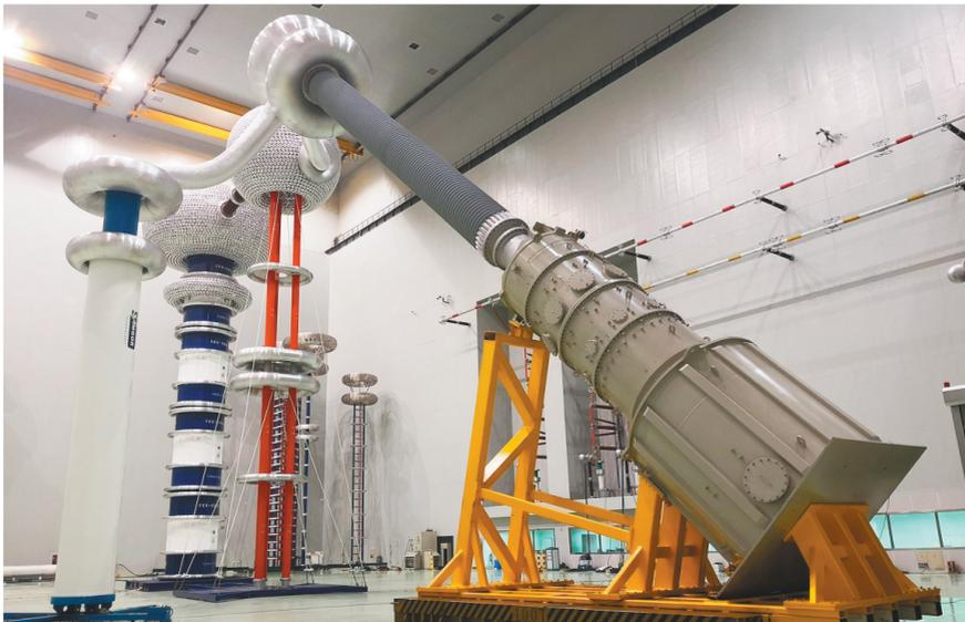
辽宁西电兴启研发的目前世界最高电压等级换流变压器阀侧出线装置。
