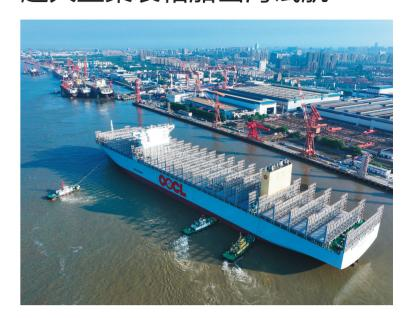
8月30日,超大型集装箱船"东方葡萄牙"轮驶离码头(无人机照 片)。当日,在边检、海事等部门的保障下,超大型集装箱船"东方葡萄牙' 轮顺利离开长江南通段水域,前往相关海域试航。据悉,该船由南通中远 海运川崎船舶工程有限公司自主研发设计建造,船长399.99米、型宽61.3 米、型深33.2米,可装载24188个国际标准集装箱。
