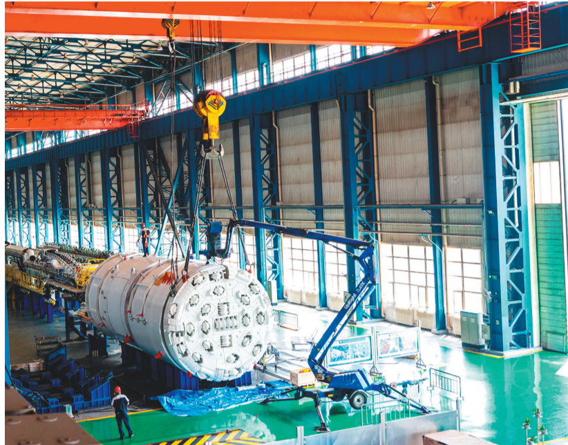
北方重工员工正在为阿克塞双护盾盾构机安装刀盘。 孙奇 摄
