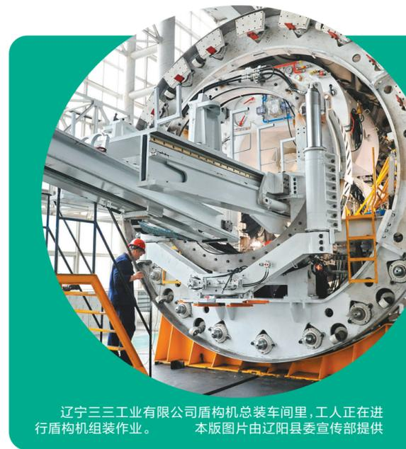
辽宁三三工业有限公司盾构机总装车间里,工人正在进行盾构机组装作业。本版图片由辽阳县委宣传部提供
