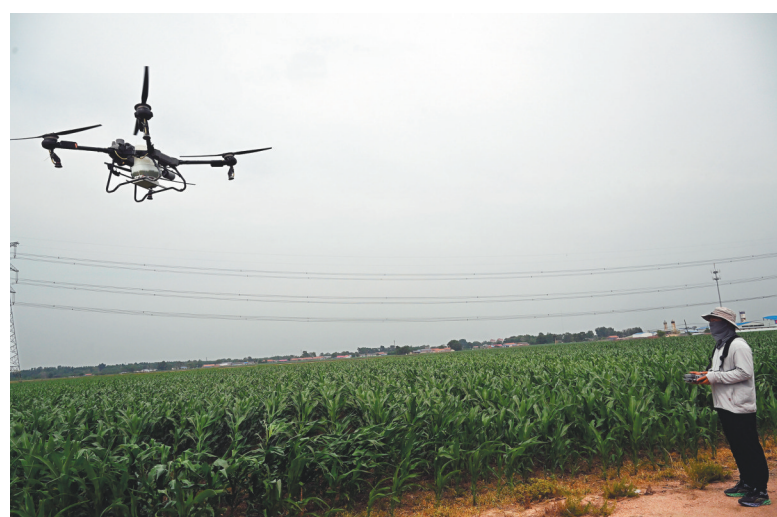
无人机投下赤眼蜂放蜂器,防控玉米螟。本报记者 赵敬东 摄
