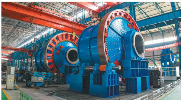
北方重工研制的湿式半自磨机、溢流型球磨机顺利下线。王宏涛 摄
