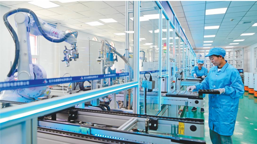
航天长峰朝阳电源有限公司模块电源自动化组装生产车间。
