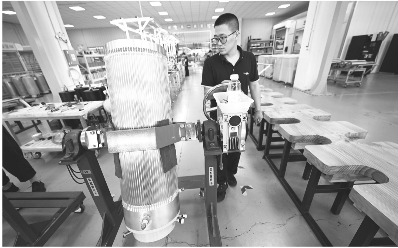
图为沈阳微控新能源技术有限公司的飞轮装配中心。
