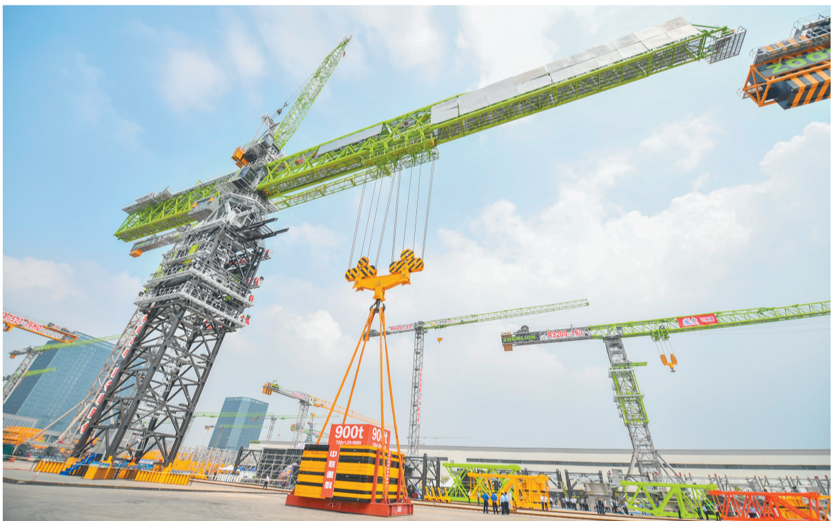
这是4月20日拍摄的中联重科R20000-720塔式起重机。当日，中联重科R20000-720塔式起重机在位于湖南省常德市鼎城区的中联重科建筑起重工业园下线并交付。该起重机最大起重量720吨，最大起升高度400米，主要应用于重大工程建设领域。 新华社记者 陈泽国 摄
