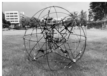
陆地机器人试验样机。是一款陆空两用全向可控的机器人。 南京航空航天大学供图
