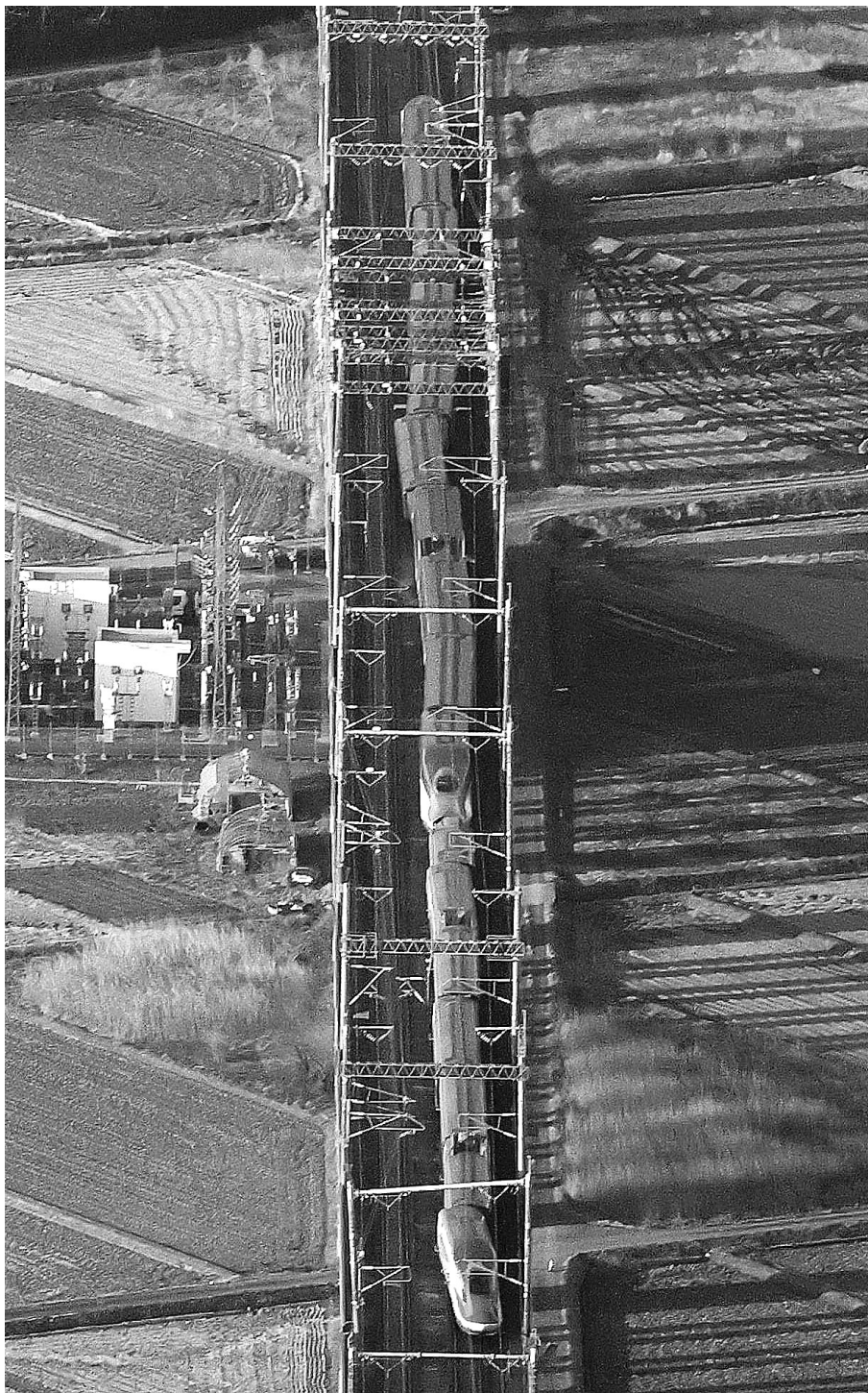
这是3月17日在日本宫城县白石市拍摄的因地震脱轨的东北新干线车体。日本福岛县附近海域16日夜间发生的地震已造成4人死亡、97人受伤。
