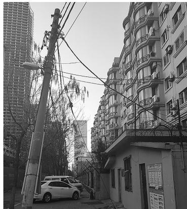
沈阳市和平区文兴路东端的人行道上有一根线杆,整体向西倾斜,上面有数根线缆。让人吃惊的是,线杆上方延伸下来一根钢丝绳竟然拴在了污水井盖上。
