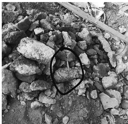
残土中可见切断的钢筋。
