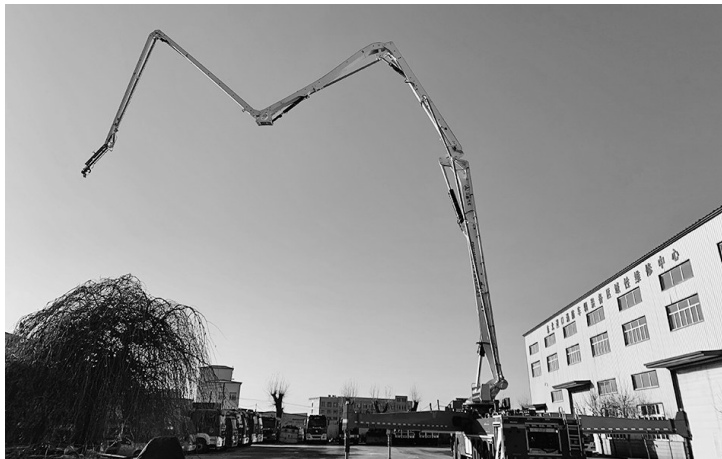
高喷消防车的大臂最远能伸展到离车56米的地方。
