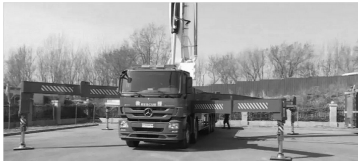
高喷消防车最前端支腿跨距是4米,在狭窄的地方也可以伸展开进行作战。
