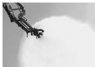
高喷射消防车一分钟能喷水4.8吨。
