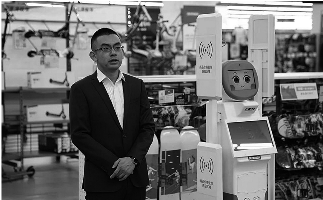
盘点机器人能解决人工盘点高成本、低准确率、数据无法直传等问题,给商场带来诸多便利。
