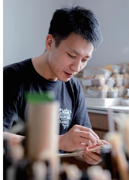
齐材子：将火通好的狼毫按照相应的制式，按照毫毛长短依次齐好。
