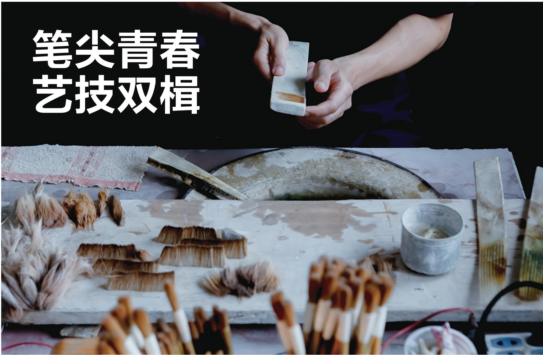
“浸、梳、齐、垫”和“绑头、选杆、择笔、粘头、刻字、检验、包装”，要150多道工序。
