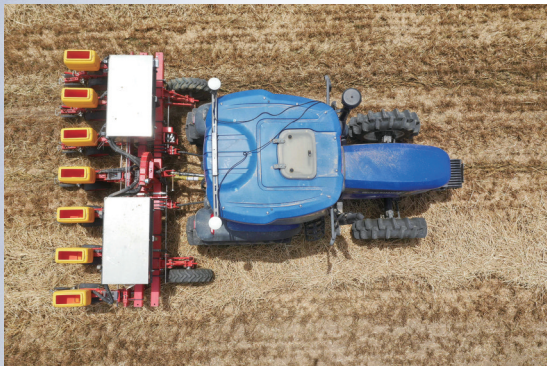
在河南省邓州市小杨营镇安众村，加装北斗导航系统的拖拉机在无人驾驶状态下播种（2020年5月26日摄，无人机照片）。
