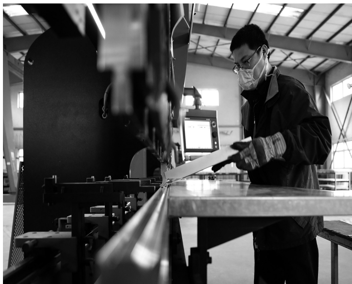
辽宁海华科技股份有限公司润滑油车间,一名工人在加工开关柜外壳。
